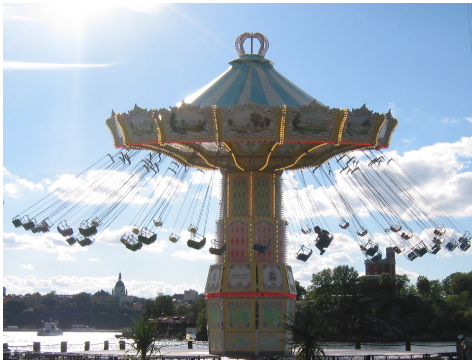
Figure 2: Kättingflygaren på Gröna Lund, De 16 gungorna i den yttre cirkeln hänger på ett avstånd av 2 m och de fyra kedjorna som håller gungorna är ca 5.5 m långa, (inklusive den extra kedjan högst upp och höjden på sätet)
